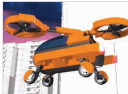
gli consente di percorrere su ruote le strade urbane, ricaricando contemporaneamente le batterie di sei rotori per la fase di volo con un'autonomia di circa 30 minuti.
