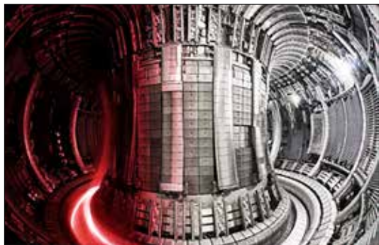
Il cuore del Joint European Torus (JET): la camera dove viene confinato (da potenti campi magnetici) e scaldato il plasma di deuterio e trizio, per innescare reazioni di fusione nucleare (fonte: JET/EUROfusion).
